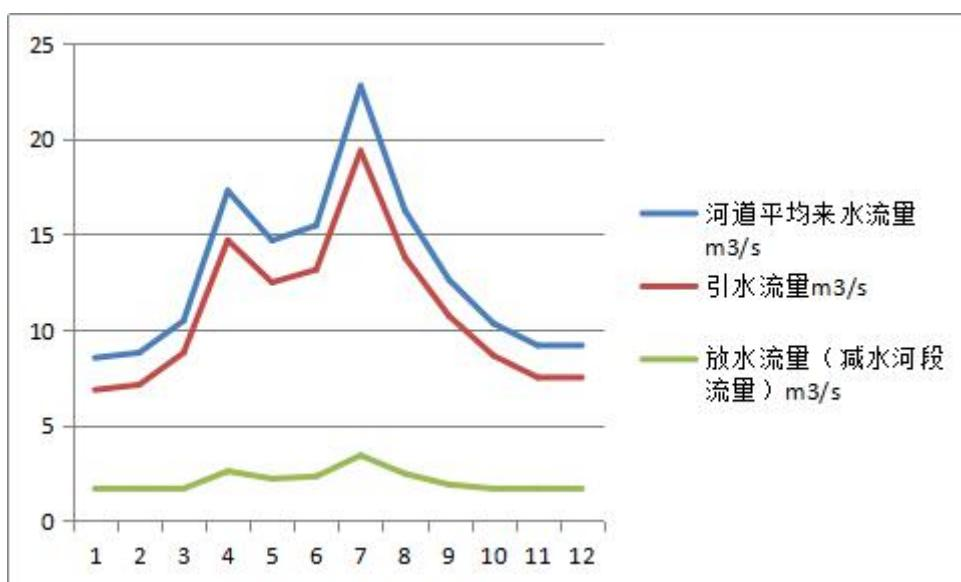
图 5-6 平水年（1985 年）枢纽断面流量变化
